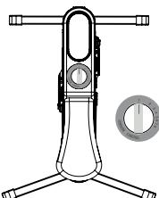
Ajustar a resistência do equipamento com a roda situada à frente do selim ao nível de intensidade desejado para o seu exercício.
