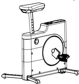
Desplegar los pedales hasta situarlos en posición perpendicular al cuerpo principal de la máquina, tirando hacia afuera y después volviéndolos a colocar en su posición natural.
