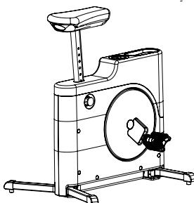
Déployer les pédales jusqu'à une position perpendiculaire à la machine, en tirant à l'extérieur et les positionnant dans sa position naturelle.
