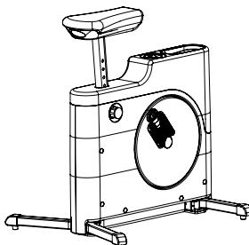
Bringen Sie den Sitz in eine aufrechte Position, in dem Sie die Schraube gegen den Uhrzeigersinn lösen. Sobald Sie die gewünschte Position erreicht haben, ziehen Sie die Schraube wieder im Uhrzeigersinn an.
