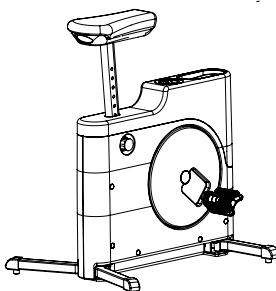
Abrir os pedais até estarem na posição perpendicular ao corpo principal do equipamento, retirando até para e depois voltar a colocar na sua posição natural.
