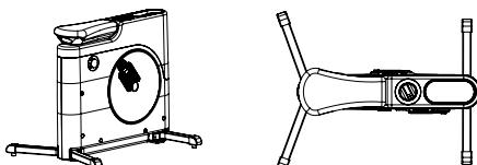
Desplegar las patas delanteras y traseras hasta esta posición.
